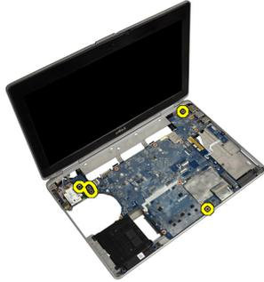
11. システム基板アセンブリの左端を 45 度の角度に注意深く持ち上げ、システム基板を右側のポートコネクタから外します。
