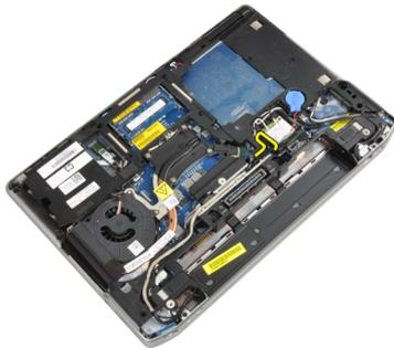
7. LVDS/ カメラケーブルを配線チャンネルから外します。
