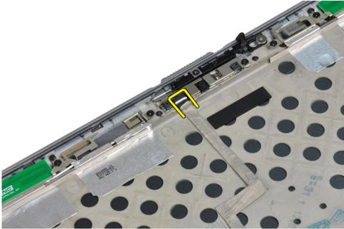
4. LVDS/ カメラケーブルをディスプレイアセンブリに固定している粘着テープを剥します。
