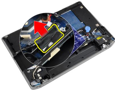
8. スピーカーケーブルをシステム基板の底部から外します。
