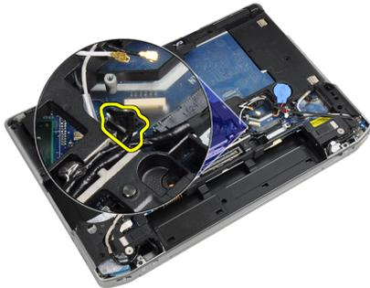
5. LVDS ケーブルブラケットを固定しているネジを外します。
