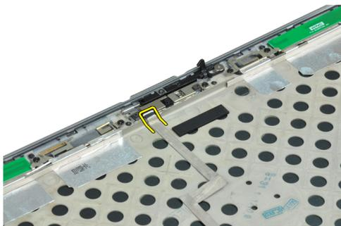
4. カメラをディスプレイアセンブリに固定しているネジを外します。
