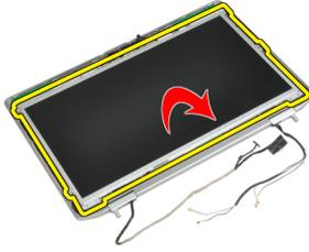
5. LVDS ケーブルコネクタのテープを剥し、LVDS ケーブルをディスプレイパネルから外します。
