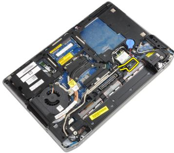
6. カメラケーブルをコンピュータから外します。
