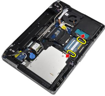
4. メモリモジュールをシステム基板上のコネクタから取り外します。
