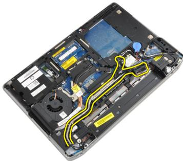
8. ワイヤレスソリューションに接続されているアンテナがあれば、すべて外します。
