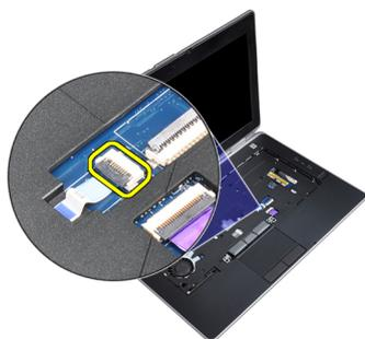
7. SD カードケーブルをシステム基板から外します。
