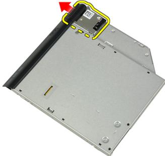
7. オプティカルドライブラッチブラケットをオプティカルドライブアセンブリに固定しているネジを外します。
