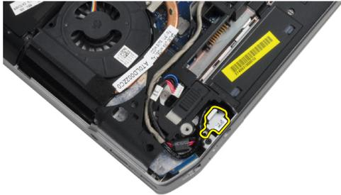
6. 電源コネクタケーブルをコンピュータから外します。
