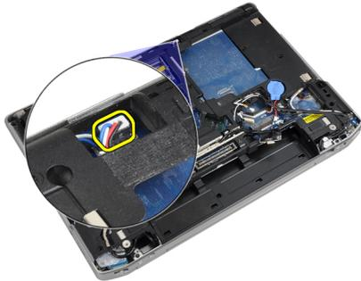
9. システムを裏返し、メディアボードケーブルをシステム基板から外します。
