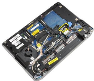
9. 配線チャンネルに接続されているアンテナがあれば、すべて外します。
