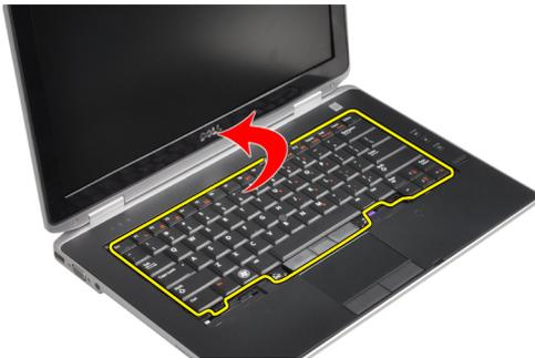
6. キーボードケーブルをシステム基板から外します。
