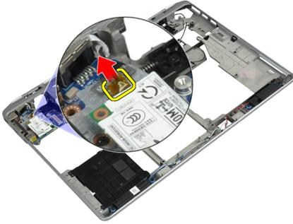
4. モデムケーブルを配線チャンネルから外します。
