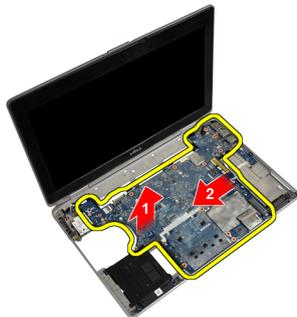
12. システム基板を後部のコネクタポートから外し、システムから取り出します。
