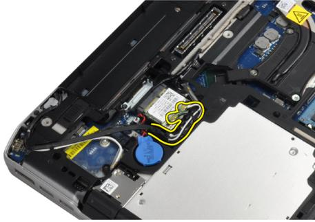
4. WLAN カードをコンピュータに固定しているネジを外します。
