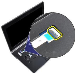
6. タッチパッドケーブルをシステム基板から外します。
