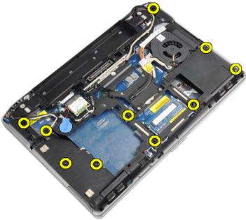
4. コンピュータを裏返し、パームレストアセンブリをコンピュータに固定しているネジを外します。
