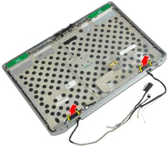
5. ディスプレイヒンジをディスプレイアセンブリに固定しているネジを外します。
