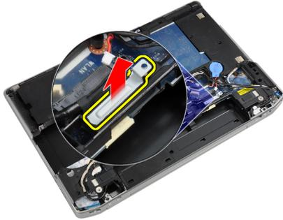
7. LVDS ケーブルをシステム基板の後部から外します。
