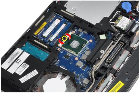
4. プロセッサをコンピュータから取り外します。
