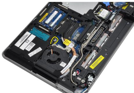
4. ヒートシンクをシステム基板に固定しているネジを外します。
