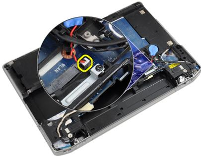
4. カメラケーブルをシステム基板の底部から外します。
