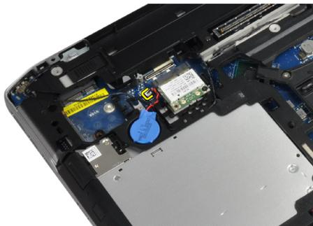
4. コイン型バッテリーを外してコンピュータから取り出します。
