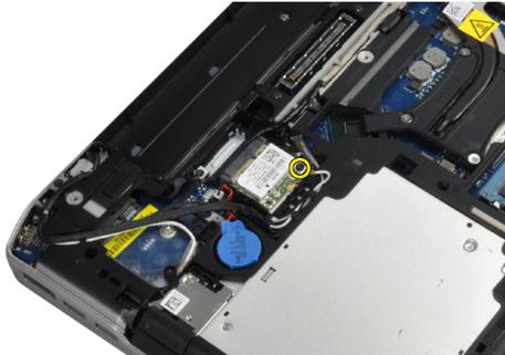
5. WLAN カードをシステム基板上のスロットから取り外します。
