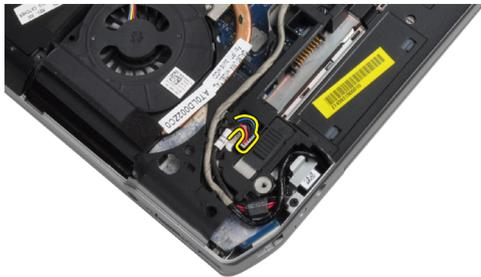
4. 電源コネクタブラケットをコンピュータに固定しているネジを外します。
