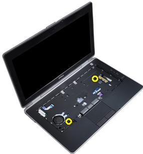
5. LED ケーブルをシステム基板から外します。
