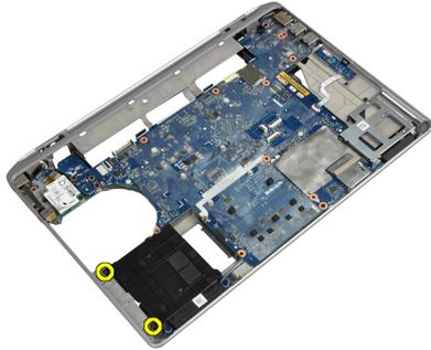
4. ハードドライブサポートプレートを持ち上げてコンピュータから取り出します。
