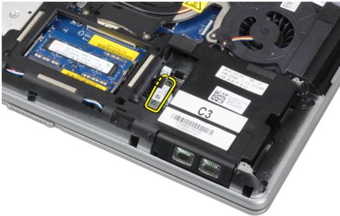
5. Bluetooth ケーブルをシステム基板から外し、カードをコンピュータから取り外します。
