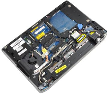
5. タブを引き上げて LVDS ケーブルをコンピュータから外します。
