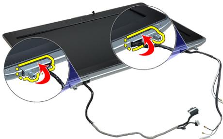
4. ヒンジキャップの端をヒンジから持ち上げて緩め、ヒンジキャップをディスプレイアセンブリから取り外します。
